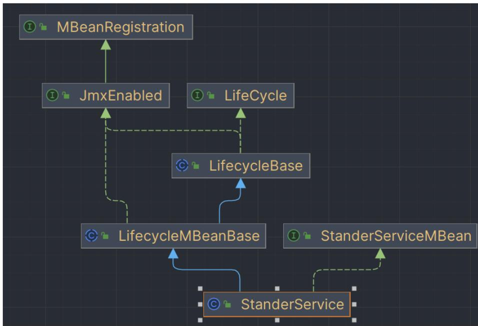
Service 组件用于为 Connector 和 Container 提供容器将两个组件连接在一起, 同时也要收到的 JMX 监管和生命周期控制
